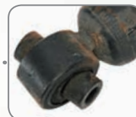
Damaged mounting Verschlissene Befestigung Vioittunut kiinnike
