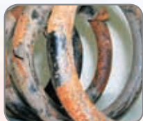
Broken Gebrochene Federwindung Vioittunut
