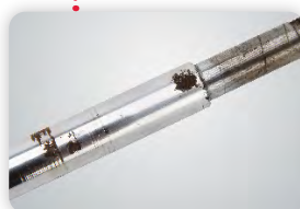
Пошкоджений шток поршня
