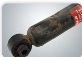
Пошкоджений корпус амортизатора
