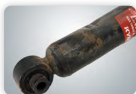
Поврежденный корпус амортизатора
