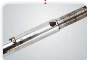
Tija pistonului deteriorată
