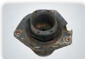
Rozerwany element gumowy górnego mocowania amortyzatora
