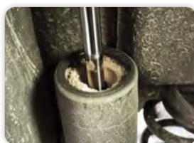
Uszkodzony, rozerwany odbój amortyzatora
